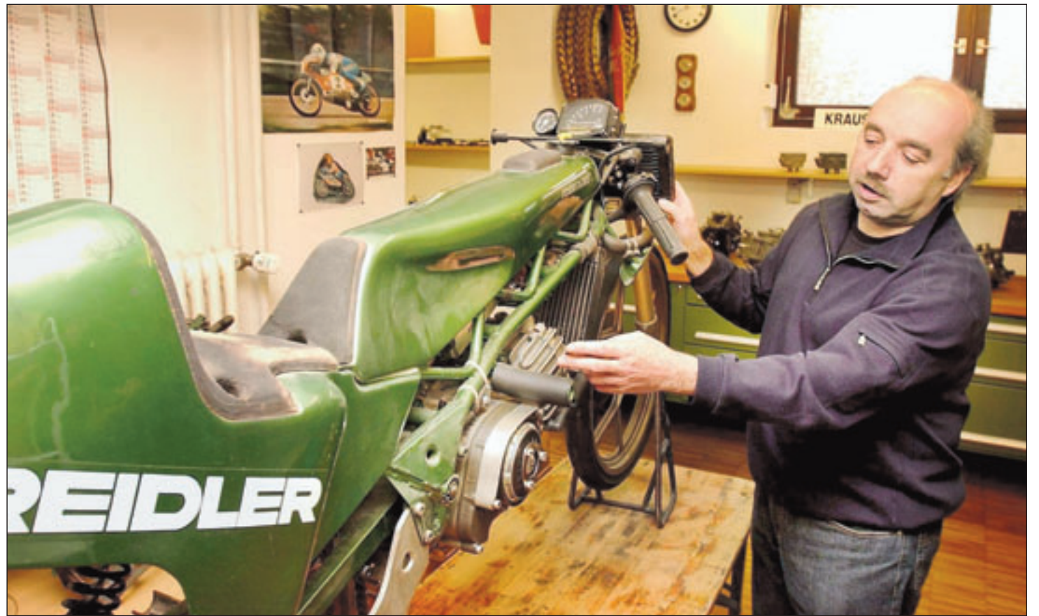
In seiner Werkstatt in Schnait pflegt Herbert Rittberger noch eine 50-Kubikzentimeter-Maschine von Kreidler Van Veen mit Wasserkühlung, Baujahr 1970/71. Nahezu den kompletten Motor hat der Tüftler selbst gebaut, ebenso das in der Mitte dieser Seite zu sehende Kassettengetriebe.
